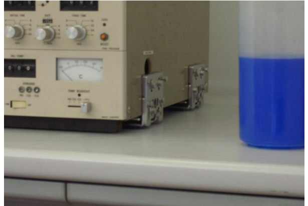
②A ガスクロ本体 サイドスター ②B ポリタン青 プロセブンマット
